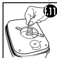
**Warnung (Nur für Modelle 104 und 204): Diese Motoreinheiten enthalten eine Keramikachse. Diese Achse ist für eine sichere Handhabung an ihrer Plastikhalterung dauerhaft angebracht. Die Achse neigt bei seitlichem Druck zu Sprödebruch. Seien Sie deshalb bei der Handhabung überausvorsichtig. Versuchen Sie nicht, die Achse zu biegen.**
