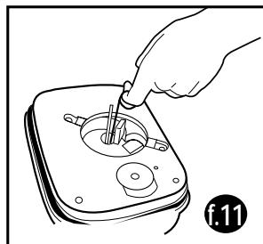
**Atención:** El motor incorpora un eje impulsor de cerámica. Dicho eje está fijado permanentemente en su soporte de plástico, para garantizar un manejo seguro. El eje es susceptible a cualquier presión lateral. Tenga especial cuidado al limpiarlo, y no intente doblarlo.
