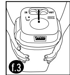
Solange die Schläuche oder der Aqua-Stop nicht gereinigt werden müssen, ist es nicht erforderlich, das Schlauchsystem vom Aquarium zu entfernen. Ein verstopfter Aqua-Stop kann zu einer reduzierten Durchflußgeschwindigkeit führen. Um eine optimale Durchflußgeschwindigkeit zu gewährleisten, wird eine regelmäßige Reinigung empfohlen.
