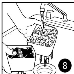
**4)** Separe la pantalla de foamex (C) y las cestas de las cargas filtrantes (D) de la caja del filtro.
