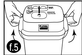
**WICHTIG:** Entfernen Sie vor dem weiteren Verfahren das Wasser aus dem Filtergehäuse. Drehen Sie die Einheit über dem Spülbecken nach unten, damit das Wasser aus dem Filter laufen kann. Halten Sie dabei die Filterkörbe fest.
