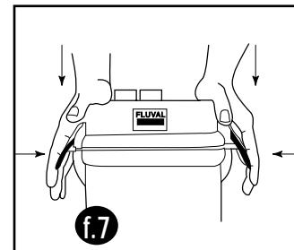
**Attendre que la cuve du filtre soit complètement remplie avant de rebrancher l'appareil. Le filtre Fluval ne doit pas fonctionner à sec. Brancher au courant électrique un filtre dont la cuve n'est pas complètement remplie peut empêcher l'auto-amorçage de fonctionner correctement.**
