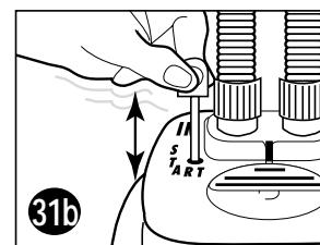
**Schalten Sie die Einheit nie ein, wenn sie noch nicht vollständig gefüllt ist. Die Fluval-Einheit sollte nie trocken laufen. Eine vorzeitige Inbetriebnahme kann den Motor schädigen.**
