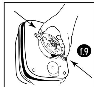
Nota: No se aconseja quitar el conjunto del eje cerámico a menos que se rompa. Para quitar el conjunto del eje cerámico amarillo del depósito del impulsor, utilice la herramienta de eje cerámico suministrada f10 f11. Para volver a colocar el conjunto del eje cerámico en su lugar, coloque el impulsor magnético en el conjunto del eje cerámico y reinsertelos en el depósito del impulsor presionando suavemente sobre el ventilador del impulsor para dejarlos fijos en su sitio.
