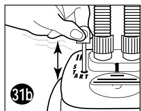
**Ne jamais brancher le filtre à la prise électrique avant que la cuve soit complètement remplie. Cet appareil ne devrait jamais fonctionner à sec. Une mise en opération prématurée pourrait endommager le moteur.**
