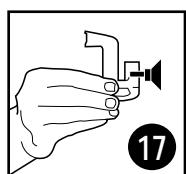
**16**) Fixer la pince de la ventouse (L) sur le tube d'entrée d'eau (K) et accolcer à l'intérieur de l'aquarium à l'endroit désiré. Pour plus d'efficacité, s'assurer que l'épurateur d'entrée d'eau (J) se situe à au moins 1 à 3 cm du fond de l'aquarium. Si c'est trop long, couper le tube d'entrée d'eau avec un couteau tranchant.
