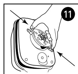
**12** Replacer le bloc-moteur (B) sur la cuve du filtre en les alignant et pousser vers le bas afin d'assurer un ajustement serré et solide. S'assurer que le cordon d'alimentation est bien aligné avec l'échancrure de la cuve du filtre. Serrer ensuite en place les manettes de blocage/déblocage instantanés (H). Si l'appareil ne se ferme pas correctement, s'assurer que toutes les pièces à l'intérieur ont été bien placées.
