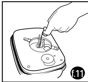
**Mise en garde : un arbre d'entraînement en céramique fait partie de ce bloc-moteur. Cet arbre est fixé de façon permanente à son support en plastique pour en faciliter la manipulation. Une pression latérale pourrait le briser. Toute manipulation doit être faite avec beaucoup de prudence. Ne pas essayer de plier l'arbre.**
