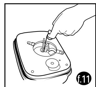
**Warnung:** Diese Motoreinheiten enthalten eine Keramikachse. Diese Achse ist für eine sichere Handhabung an ihrer Plastikhalterung dauerhaft angebracht. Die Achse neigt bei seitlichem Druck zu Sprödbruch. Seien Sie deshalb bei der Handhabung überausvorsichtig. Versuchen Sie nicht, die Achse zu biegen.
