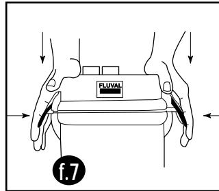
Spülen Sie die Filtermedien oder ersetzen Sie diese, je nach Bedarf. Das Filtergehäuse sollte immer dann gespült werden, wenn die Filtermaterialien gereinigt oder gewechselt werden. **Benutzen Sie NIEMALS Seife oder Reinigungsmittel für die Reinigung.** Alle verbleibenden Spuren davon könnten empfindliches Fischgewebe beschädigen.
