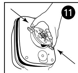
**6)** Vuelva a colocar la pantalla de foamex (C) en la caja del filtro. Observe el dibujo para hacerlo correctamente.
