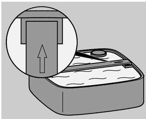
Nel bordo superiore del contenitore del filtro, nella griglia di copertura e nei cestelli dei filtri ci sono delle frecce per il corretto allineamento.
