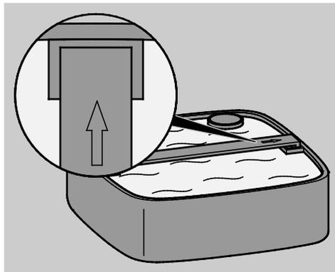
Le bord supérieur du corps du filtre, la grille de protection et les paniers de filtration présentent des flèches qui servent à les aligner correctement.
