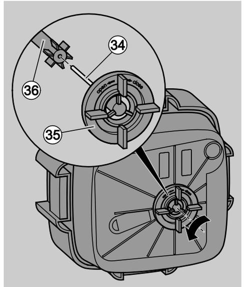
Der Impeller befindet sich auf der Unterseite des Filterkopfes. Der Impeller besteht aus Flügelrad (36) und Impellerschaft (34).
