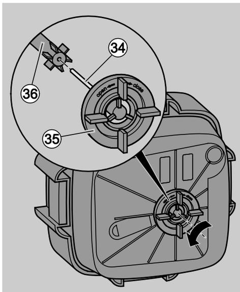
De waaier bevindt zich aan de onderzijde van de filterkop. De waaier bestaat uit een waaier (36) en een waaerschacht (34).
