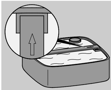
Vid ovankanten av filterbehållaren, vid skyddsgallret och vid filterkorgarna finns pilar som visar rätt håll.
