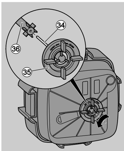
Rotor je na dolní straně hlavy filtru. Rotor se skládá z oběžného kola (36) a hřídelky (34).
