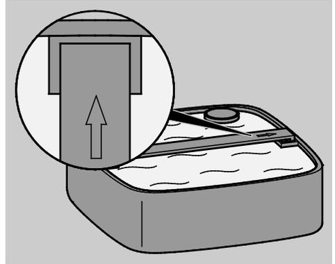
En el borde superior del depósito, en la rejilla superior y en las jaulas de los filtros hay flechas marcadas para facilitar la correcta colocación.
