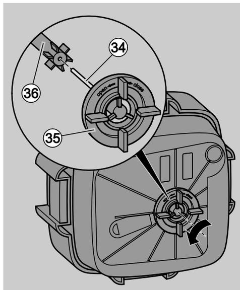
Impelleren befinder sig på undersiden af filterhovedet. Impelleren består af et vingehjul (36) og impellerskafte (34).
