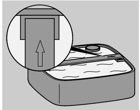
An der Oberkante des Filterbehälters, am Abdeckgitter und an den Filterkörben befinden sich Pfeile zur korrekten Ausrichtung.
