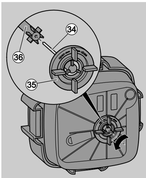
Ротор находится в нижней части головы фильтра.. Ротор состоит из лопастного колеса (36) и керамической оси (34).
