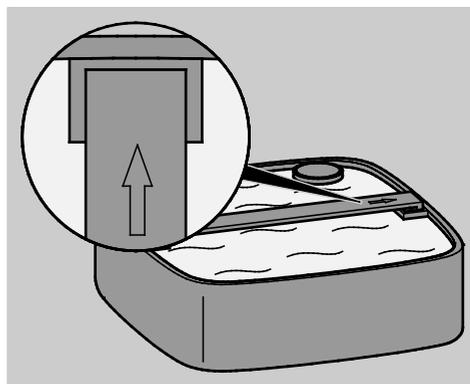
Na górnej krawędzi obudowy filtra, na siatkę przykrywającą i na koszach filtra znajdują się strzałki wskazujące ich prawidłowe ułożenie.
